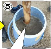
しばらく待ち、海水が砂 に吸い込まれたら、地固 め棒でついて固めます。
